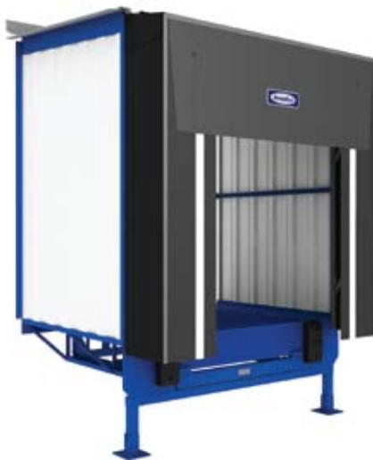
Перегрузочные тамбуры легкой серии D.HOUS. S92/93/94/95 (45°/60°/90°) выпускаются для уравнильных платформ с поворотной аппарелью серий DLHН2518Е и DLHН2520Е. Отличаются более легкой и технологичной конструкцией - стены выполнены из С-образных профилей, крыша - из профлиста С44. Допустимые размеры уравнильной платформы - 2000х2500 мм и
