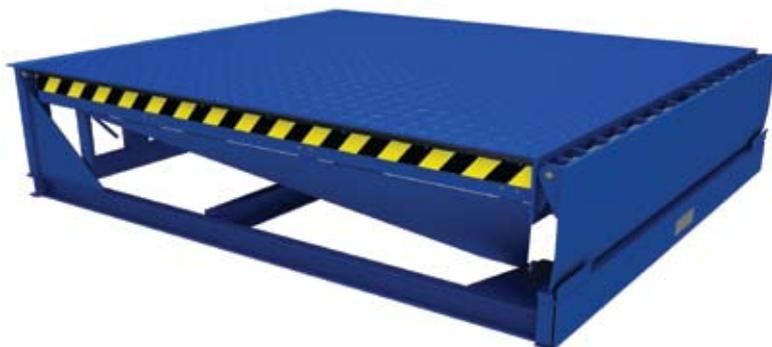
Электрогидравлические уравнительные платформы с поворотной аппарелью серии DLНН являются наиболее типовым устройством, позволяющее организовать перегрузочное место и обеспечить быструю погрузку и разгрузку. При активации платформа поднимается и аппарель, поворачиваясь, открывается. Далее платформа опускается, пока не достигнет пола кузова авто-
