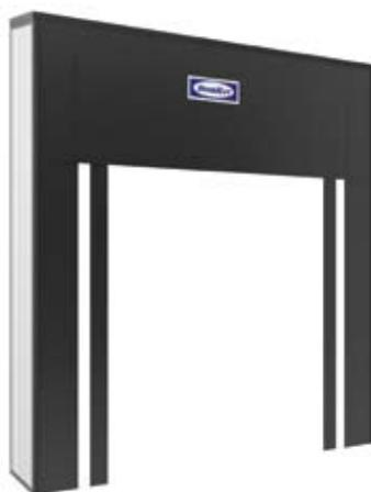
Герметизаторы проема с жесткой рамой серии D.SH-RD функционально рассчитаны на большой грузопоток, что проявляется в их конструкции. Рама изготавливается из сэндвич-панелей, окантованных алюминиевым профилем. Фронтальная прижимная планка выполнена из алюминиевого профиля, окрашенного порошковым способом. Материал фронтальных листов достаточно эластичный, обладает высокой износостойкостью и сопротивлением на разрыв. При проведении
